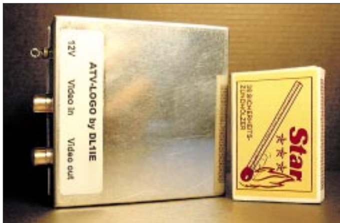
Bild 1: Ein Weißblechgehäuse mit den Maßen 74 mm × 74 mm × 30 mm nimmt die Baugruppe auf und sorgt gleichzeitig für HF-technisch saubere Abschirmung. Die Ein- und Auskopplung des Videosignals erfolgt über Cinch-Buchsen.
