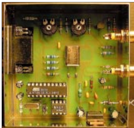
Bild 7: Fertig bestückte Platine, in einem Standard-Weißblechgehäuse untergebracht
